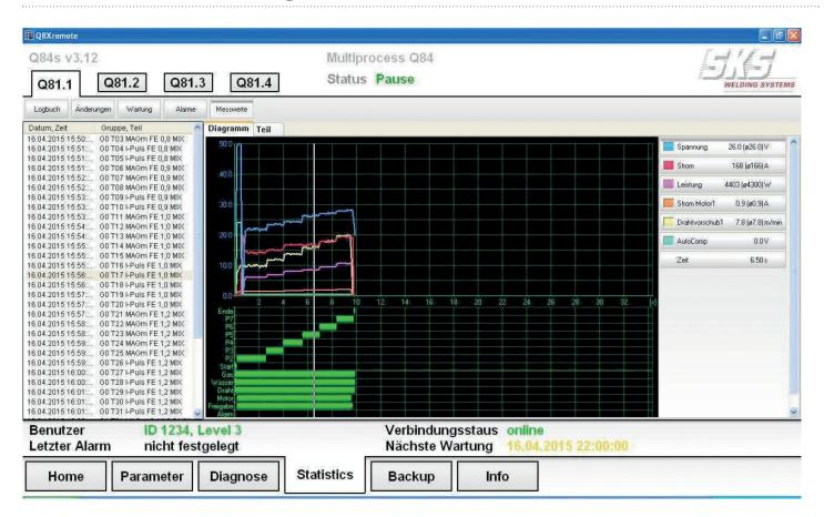
Messwertaufzeichnungen mit den dazu gehörenden Schweißparametern des Schweißsystems werden chronologisch sortiert gelistet. Dies unterstützt eine schnelle Parameterfindung bei neuen Bauteilen. Zudem können die Messwerte zur Qualitätssicherung hinzugezogen werden.
