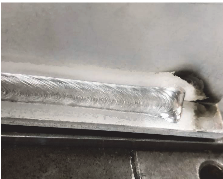
Abb. 2: Aluminium Kehlnaht mit DP-Fast
