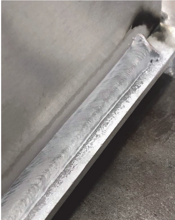
Abb. 1: Aluminium Kehlnaht mit DP-Fast
