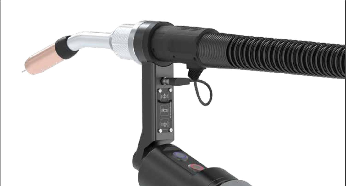
Das Brennersystem Cobot Power Clutch perfektioniert das Zusammenspiel von Schweißanlagen und Cobots mit außenliegendem Schlauchpaket. Das SKS Eindraht Brennersystem besteht aus einem roboterspezifischen Anschlussflansch, der Cobox, einem Brennerhalter, dem Brennerkabel und dem Brennerhals mit den entsprechenden Verschleißteilen. Der Wechsel des Brennerhalses ist werkzeuglos ausgelegt. So wird bei einem Brennerhalswechsel ein TCP mit einer Genauigkeit von bis zu  $\pm 0,2$  mm erreicht.
