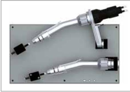
Prüfvorrichtung zur Kontrolle des TCP von Brennerhälsen und des Gesamtbrennersystems.
