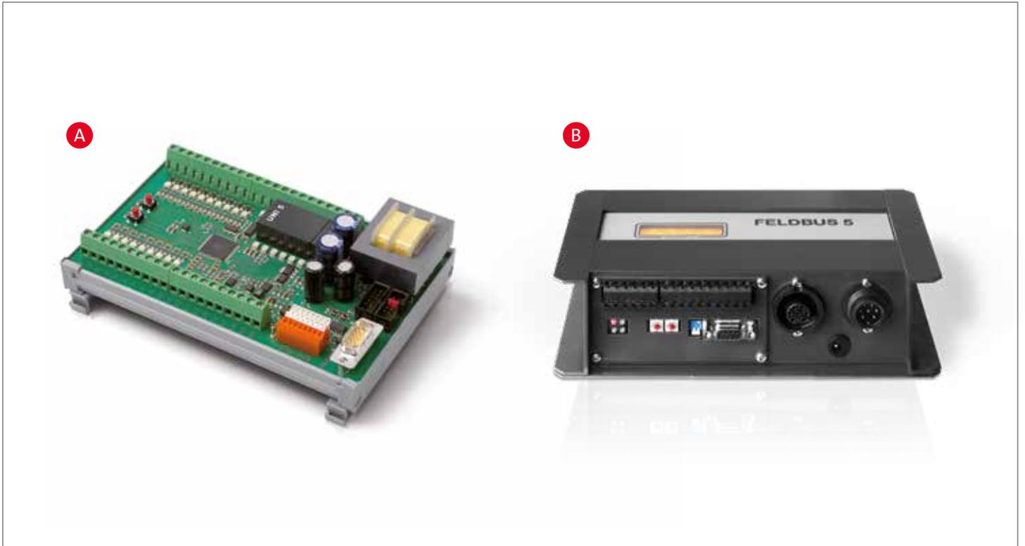
Mit der universellen Interface Lösung können Schweißmaschinen an alle Industrieroboter angebunden werden. Für die Verbindung von Roboter und Schweißmaschine haben Anwender grundsätzlich zwei Möglichkeiten: Entweder kann die Schnittstelle mit dem Interface UNI 5 hergestellt werden oder die Schweißmaschine wird mit dem Feldbus-Interface FB5 perfekt in eine bestehende Feldbusumgebung integriert.
