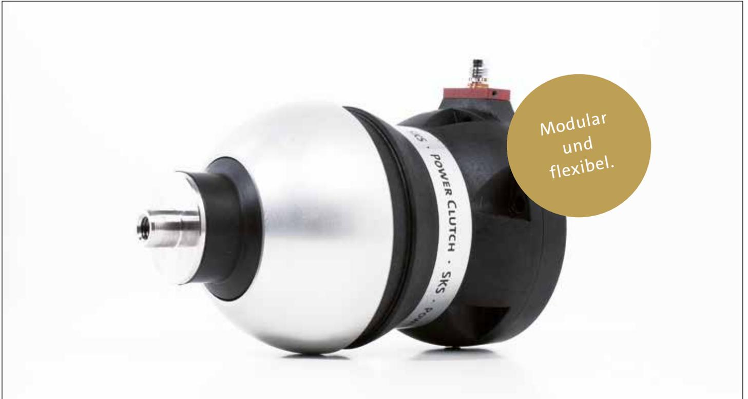
Das Brennersystem Power Clutch perfektioniert das Zusammenspiel von Schweißanlagen und Robotern mit außenliegendem Schlauchpaket. Das SKS Eindraht Brennersystem besteht aus dem Kollisionsschutz Power Clutch, einem roboterspezifischem Anschlussflansch, dem Brennerkabel und dem Brennerhals mit Verschleißteilen. Der Wechsel des Brennerhalses ist werkzeuglos ausgelegt. So wird bei einem Brennerhalswechsel ein TCP mit einer Genauigkeit von  $\pm 0,2$  mm erreicht.
